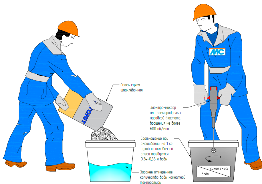
Рис. 31. Организация работ по затворению сухой шпаклевочной смеси
